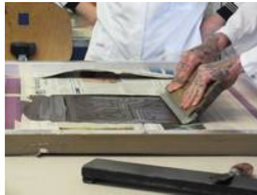
Ausführung der klassischen Siebdrucktechnik
