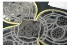
Das verlötete Messing-U-Profil an einer anderen Felderform
