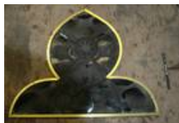
Umlaufend ist nun der Messingrahmen und kann verlötet werden
