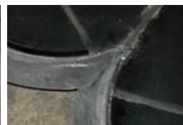
Das verlötete Messing-U-Profil an einer anderen Felderform
