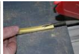
Ausschneiden der Basis des Messing-U-Profils zur Vermeidung von Lücken
