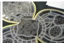
Das verlötete Messing-U-Profil an einer anderen Felderform
