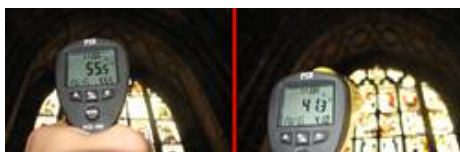
Temperaturvergleich, links eine herkömmliche Schutzverglasung, rechts unsere UV- und IR-Schutzverglasung
