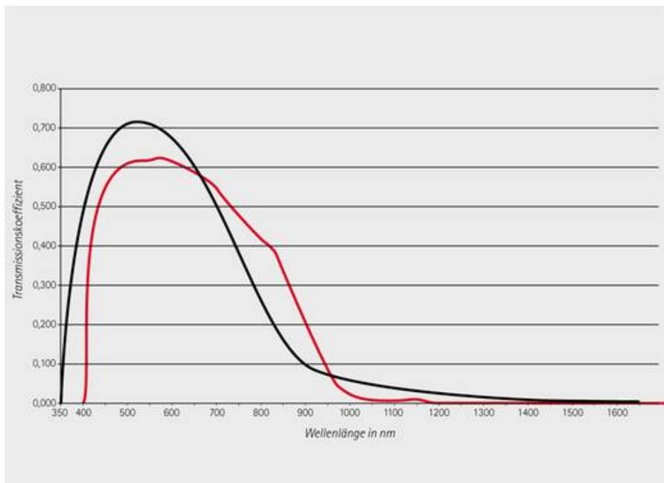
Vergleich unterschiedlicher Schutzgläser in einem Projekt. Unser objektspezifisch abgestimmtes Sonder-Strahlungsschutzglas (rot) und ein Vergleichsprodukt (Wärmeschutz isolierglas mit Bedampfung). Gut zu erkennen ist die bessere Farbwiedergabe im roten Bandenbereich bei gezielter und gleichmäßig gesenkter Transmission im sichtbaren Bereich sowie deutlich besserer Blockade der UV- und kurzwelligen Schädstrahlung.
